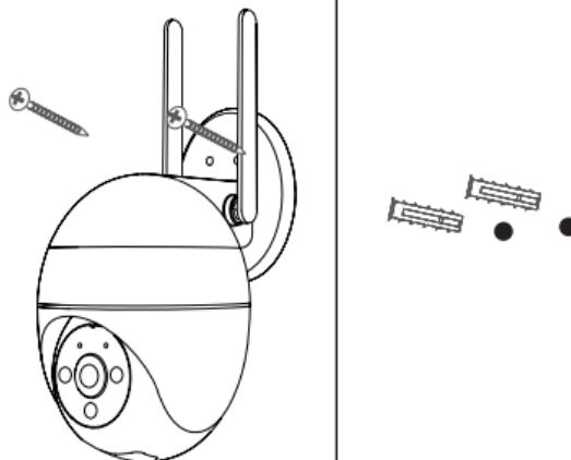
1. Připevněte kameru ke zdi pomocí šroubu.
