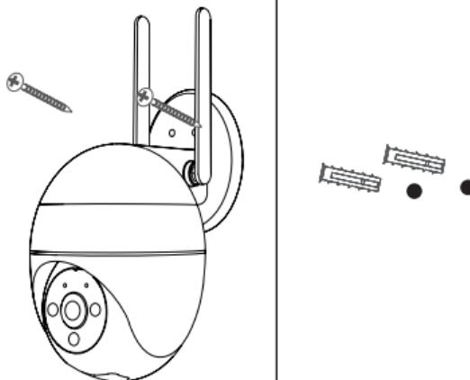
1. Festigen der Kamera an der Wand mit den Schrauben.
