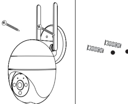
1. Przymocuj kamerę do ściany za pomocą śrub.
